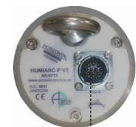
2 x Salida analógica 0-4/20mA Comunicación CAN y RS-485
